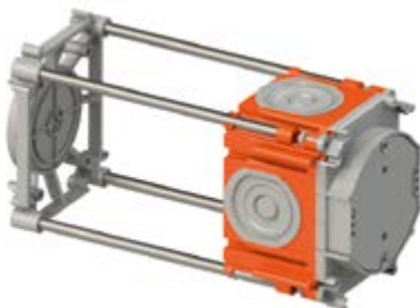
délka rozpěrných tyčí = tloušťka realizované stěny - 45 mm
